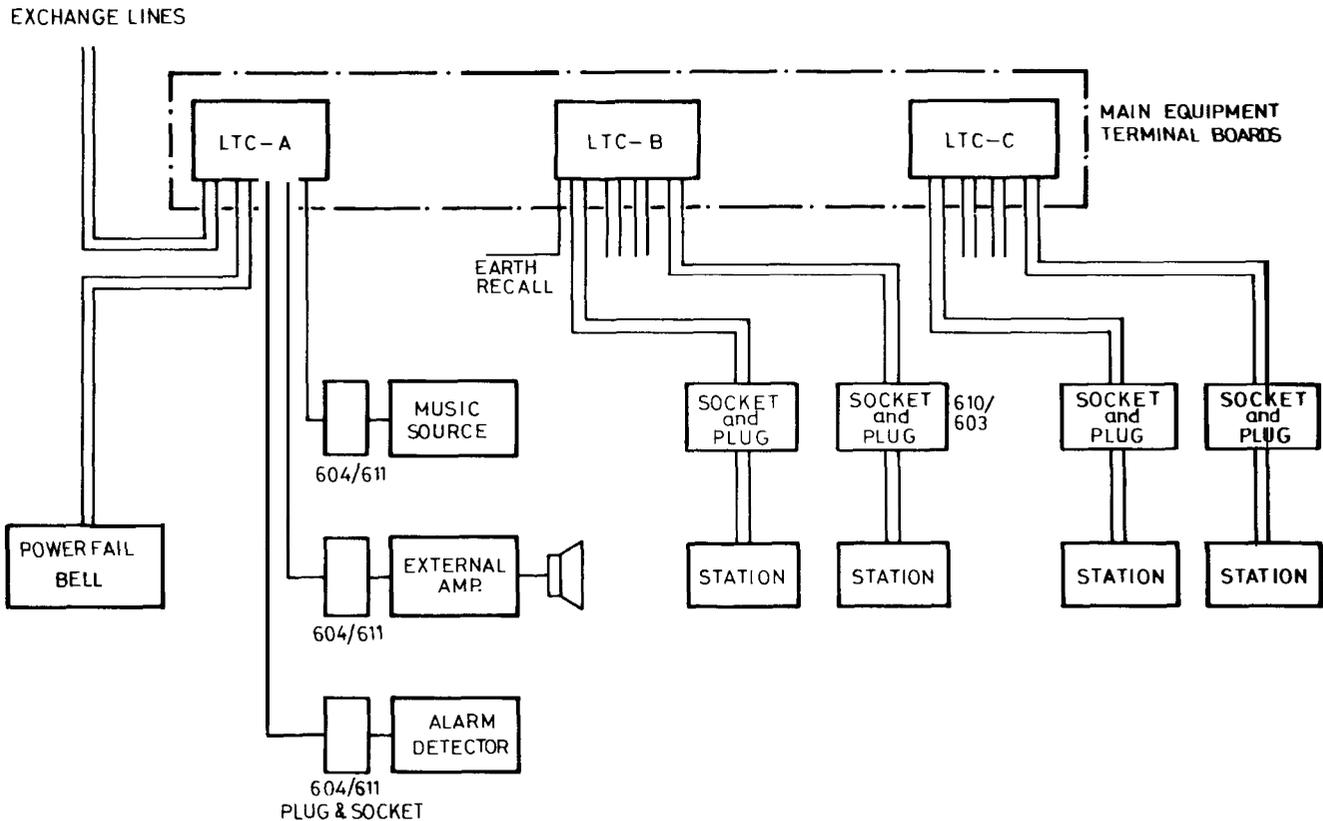
FIG. 39 - N308 SYSTEM LAYOUT
