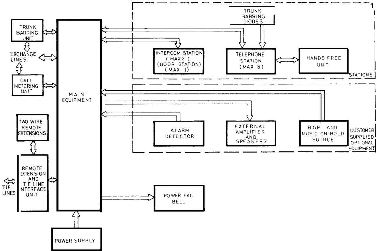
FIG. 6 - N308 SYSTEM BLOCK DIAGRAM
